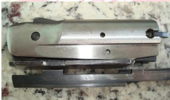
Vista lateral do conjunto do ferrolho com detalhe do encaixe nas hastes da corredeira.
