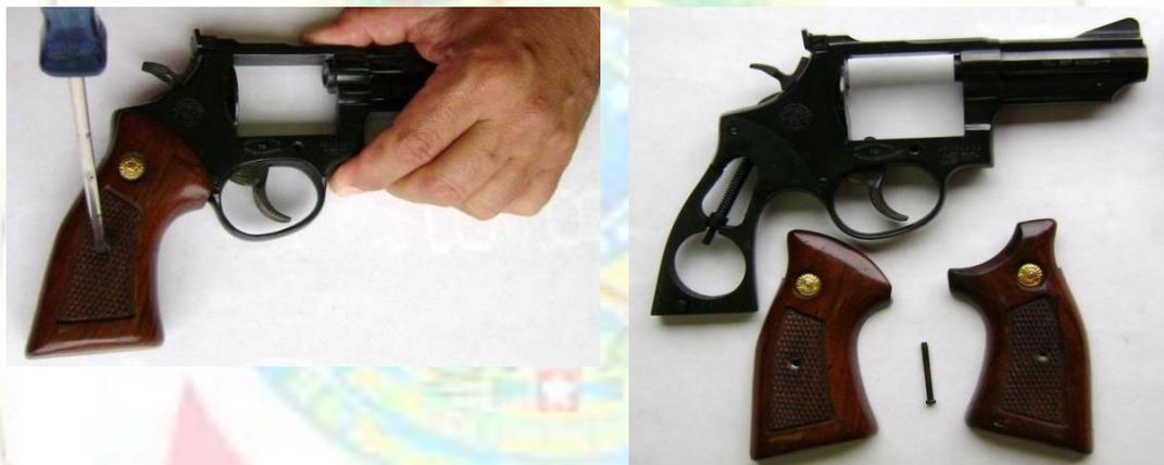
7) Retirar o parafuso da placa no mecanismo e, após, com o auxílio da chave de fenda, fazer uma alavanca para retirar a placa;
