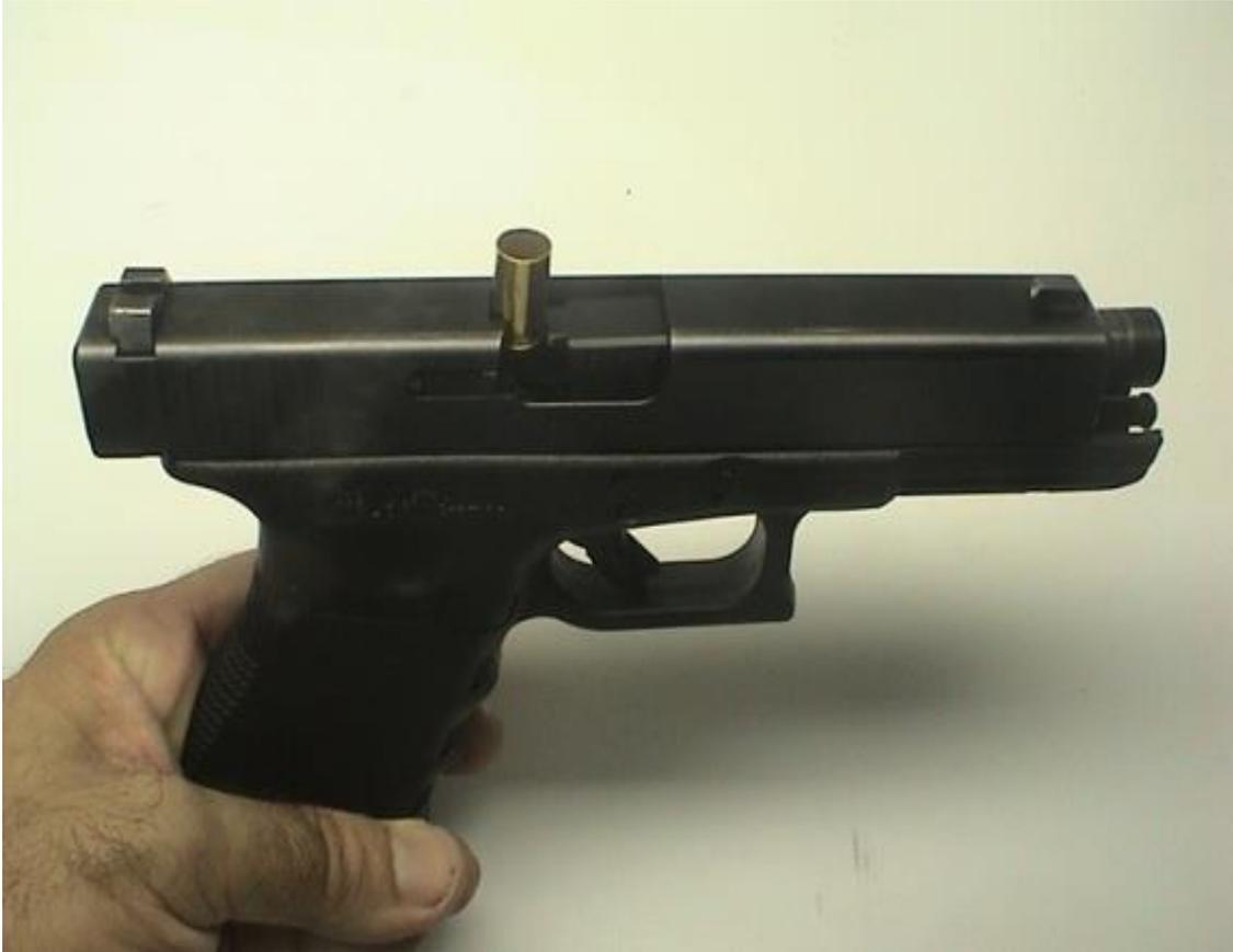
É caracterizada pela falha na ejeção da cápsula, fazendo com que o ferrolho “morda” o culote do estojo, que fica preso na janela de ejeção, geralmente num ângulo de 90°, lembrando uma chaminé. Essa pane impede a ejeção do estojo, impossibilitando que ocorra uma nova alimentação.
