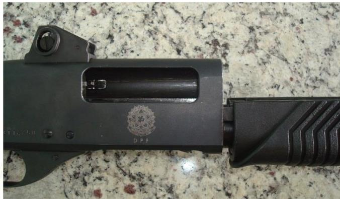
Segure o cano paralelamente ao tubo de depósito e introduza a extremidade traseira no receptáculo.
