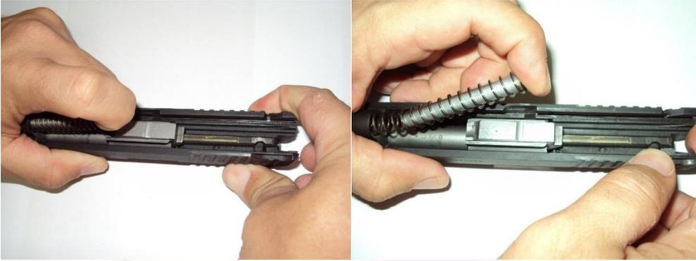
Pressione o conjunto da guia e da mola recuperadora para frente e para cima, proporcionando o seu desencaixe do ferrolho e do cano.
