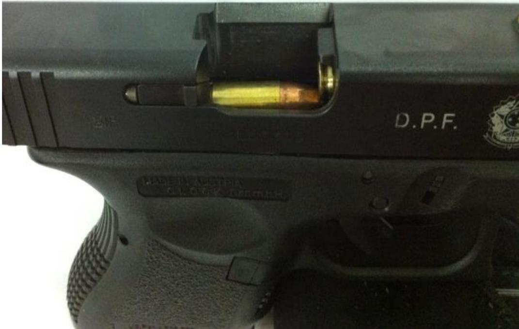
Pode ocorrer por recarga de má qualidade, quando o estojo fica estufado por excesso de pressão, amassamento do cartucho ou sujeira na câmara de explosão.
