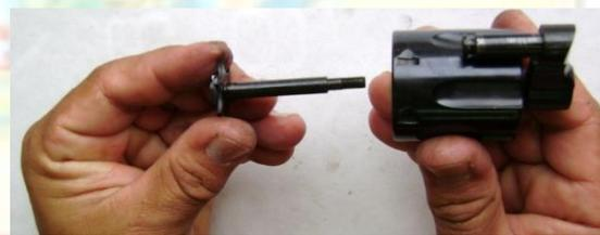
5) Para desmontar o conjunto do tambor, remover o suporte do tambor, a mola do extrator com o anel. Com o auxílio de uma chave de fenda, retirar a bucha elástica, empurrando-a pelo alojamento do conjunto do extrator;
