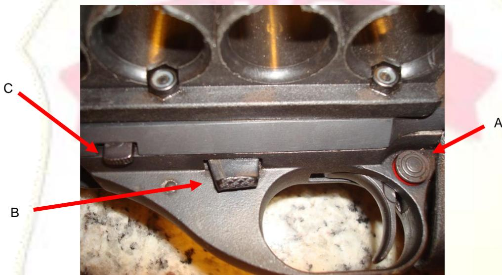
Trava de segurança (A): A trava de segurança bloqueia o gatilho e o martelo. Para travar, mover o botão da esquerda para direita, de modo que a faixa vermelha não fique visível. Quando a faixa vermelha está visível, significa que a arma está pronta para o disparo. Só é possível travar a arma quando o mecanismo de disparo está armado;
